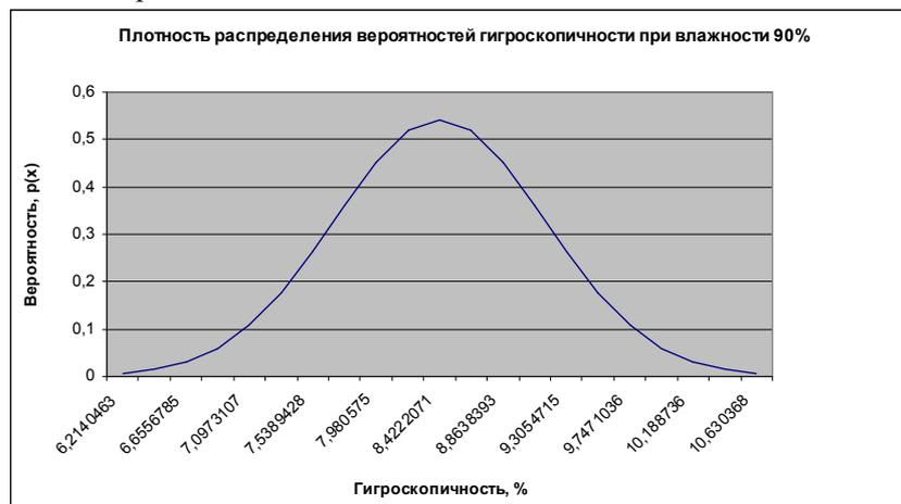
Рисунок 2 – Плотность распределения вероятностей гигроскопичности при влажности, равной 90%
